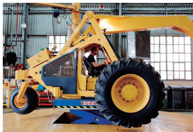
ケーンローダーの動作テストの様子
