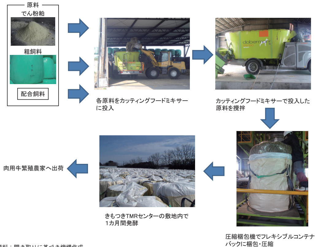
図7 TMRの製造工程
