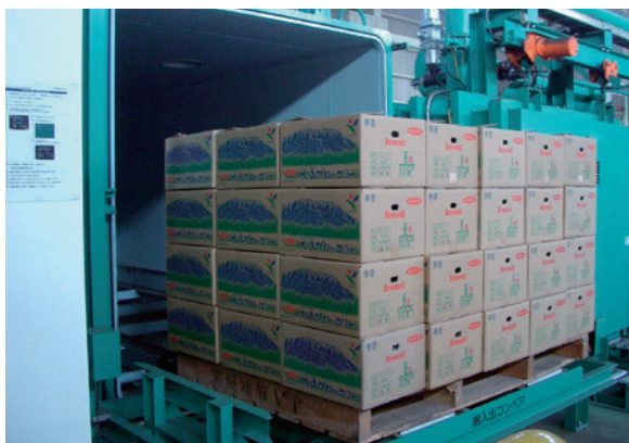
写真7 真空予冷装置
