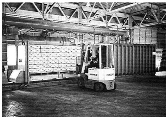
写真1 真空冷却装置の例 （左側の台車ごと青果物が右側の真空チャンバに収納され冷却が開始される）
