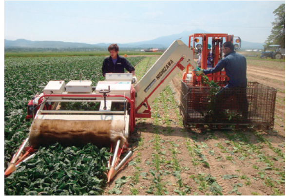
写真5 加工用ほうれんそうの収穫風景 株上を刈り取り、鉄コンテナに積み込む。 圃場には株が残されている。
