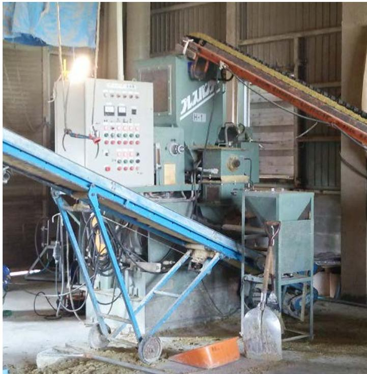
図2. 粉殻蒸碎膨軟処理装置
