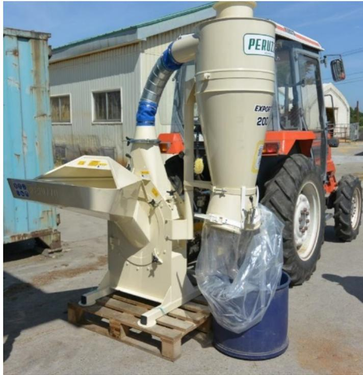
図1. ハンマーミル式破碎装置
