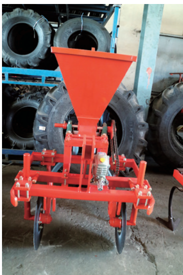
写真7 PTO駆動の小型施肥機
