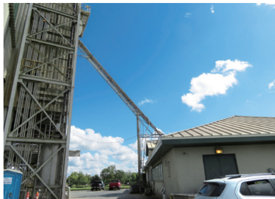
コラム2 写真10 搬入ライン上から抽出されたサンプルが管理棟内検査室へ送られるライン。
