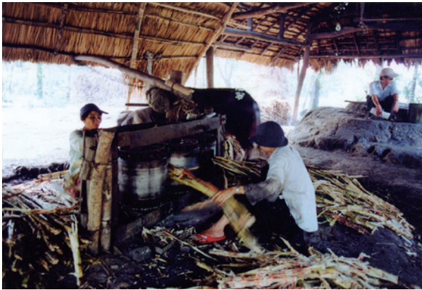
写真6 サトウキビの茎をローラーの間に入れる人とそれを受け取る人を圧搾機の両側に配す
