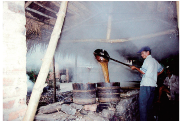
写真3 出来上がった糖蜜をくみ上げる様子
