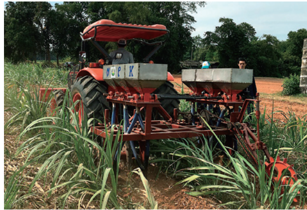
写真8 窒素、リン酸、カリを個別調整可能な管理機
