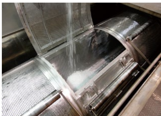
クリスタル型を製造する際に使われる網目状の円筒（クリスタライザー）
