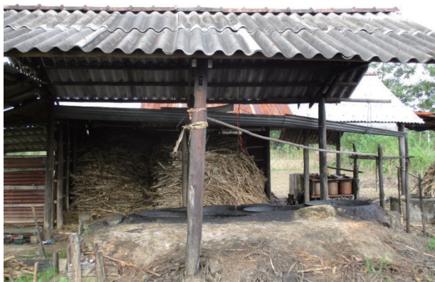
写真13 工房の全様 （手前がかまど。右手奥が6連式の垂直ローラーによるサトウキビの茎の圧搾機である。中央奥がバガスの山）
