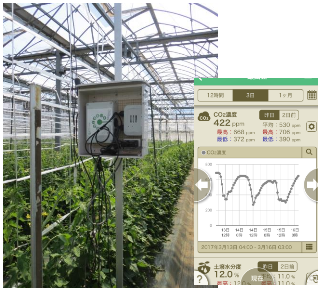
写真1 モニタリング機器で測定したデータをスマートフォンで確認
