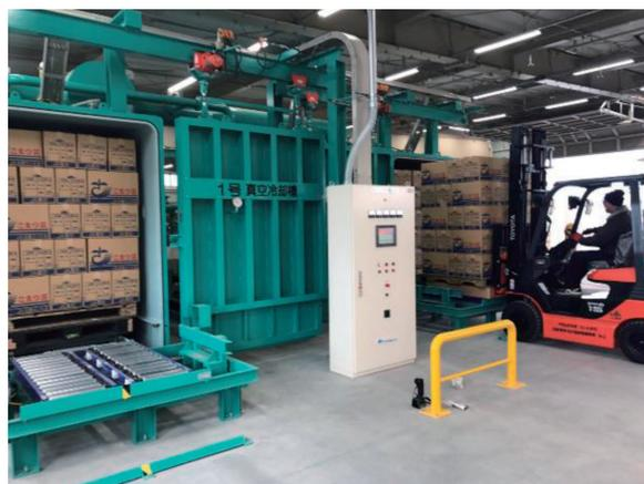
写真4 真空予冷装置で急速冷蔵する
