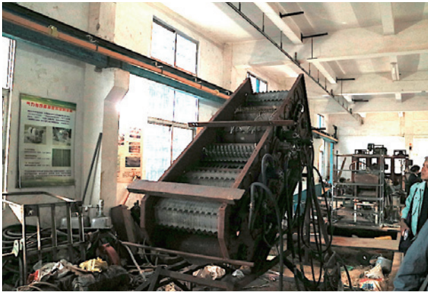
写真10 ハーベスタのベスカッターからチョッパーまでを模した実験装置
