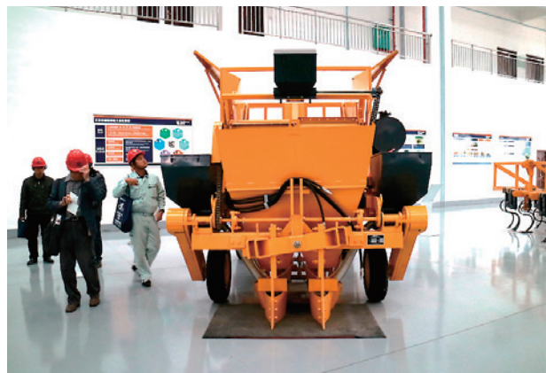
写真5 2条植え方式のピレットプランタ
