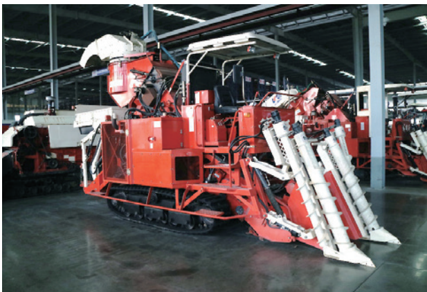
写真2 文明農機のHC-50をモデルにした小型収穫機4GZ-56
