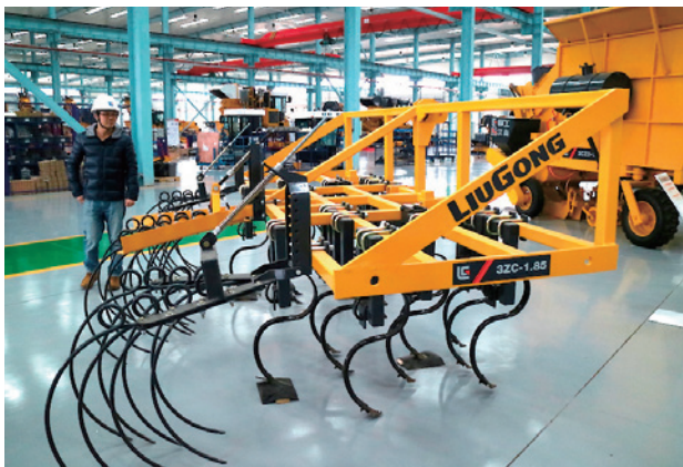
写真8 動力を必要としないけん引タイプの作業機
