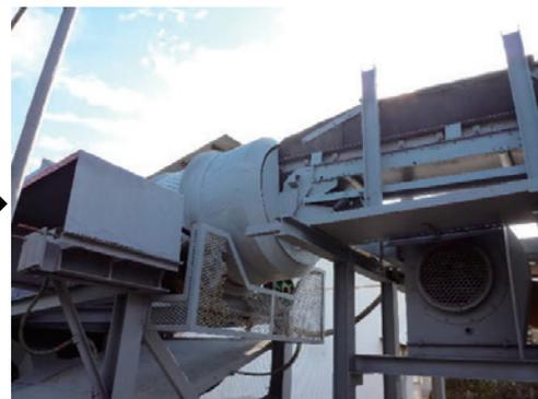
送風機により、サトウキビより軽いハカマ（枯葉）を飛ばして、原料と分ける
