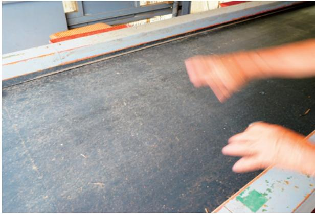
写真6 サトウキビが重ならないよう幅を広げたベルトコンベア
