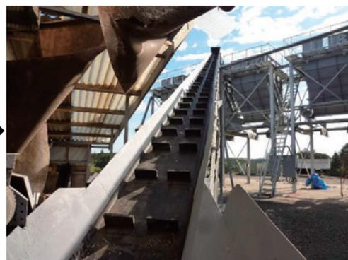
選別した原料を一旦、タンク(写真右上)に詰め、トラックに積み込む
