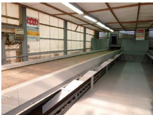
2列のベルトコンベアで計16人の作業員が原料と梢頭部を含むトラッシュ（夾雑物）を選別する
