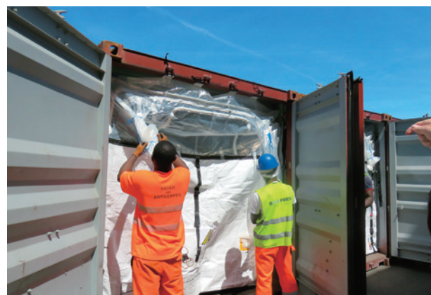
コラム2-写真6 輸出形態②バルクコンテナ (内部) (ビニール袋がインライナー)
