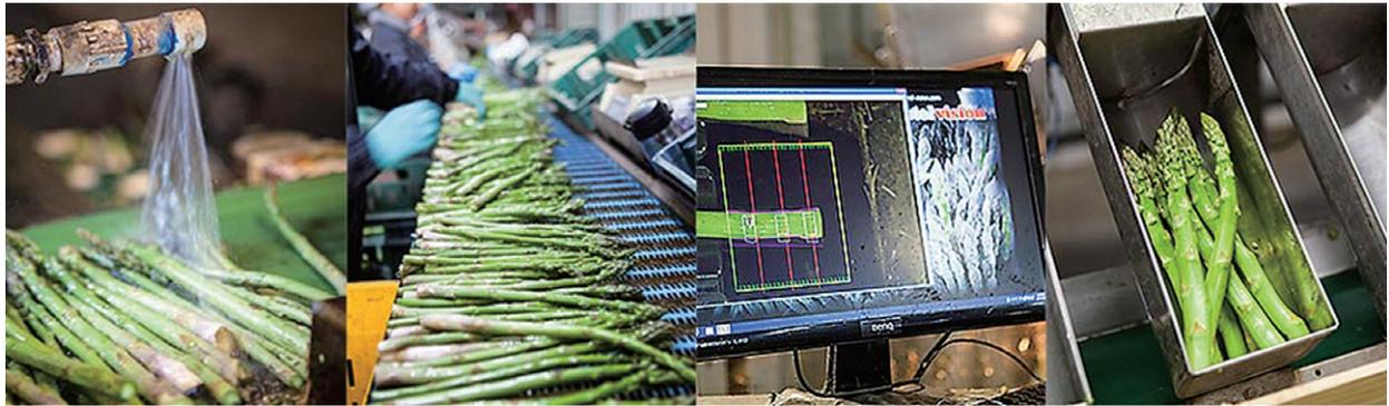
写真5 パックハウスでは、洗浄されたのち、太さで選別される（AAC提供）
