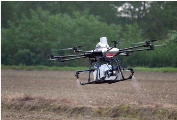
写真3 X-F1による農薬散布の様子
