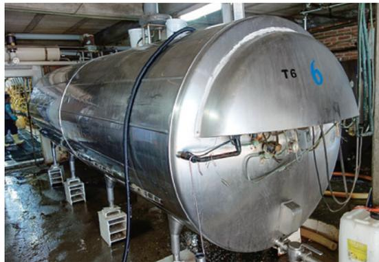
写真7 6台のバルククーラーを所有。クーラーの温度は4℃
