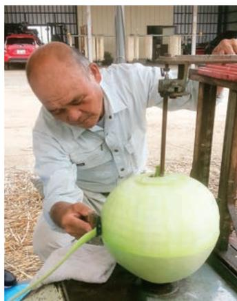
写真2 須藤さんの場合、電動式のかんぴょうむき機で幅3.3cmのひも状にむいていきます。1個当たり約30mの長さになります。
