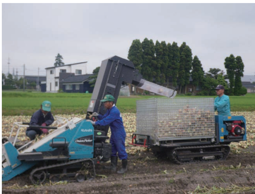
写真1 昇降機を装着した鉄コンテナ仕様のたまねぎピッカー
