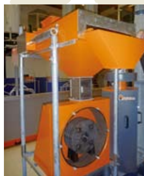
リキッドフィーディングシステムで利用するため、収穫した自給穀物は、経営内に設置したミルで破碎する。(写真は、ビッグダッチマン社本社内展示場のもの)
