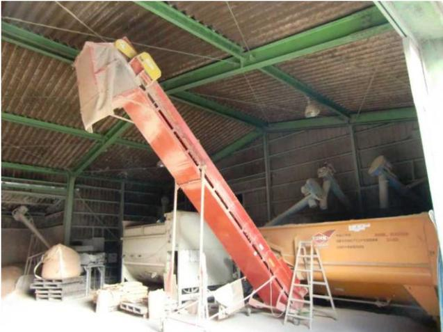
写真1 穀物類用の破碎機と飼料混合機。
