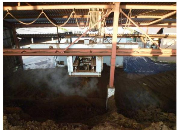
写真3 D牧場グループの堆肥の攪拌装置
