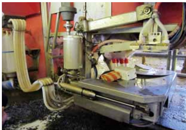
空気に触れることなくパイプを通して保冷タンクに運ばれます。
