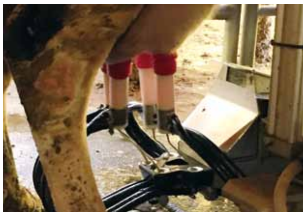
センサーで乳頭の位置を確認し、カップを装着します。
