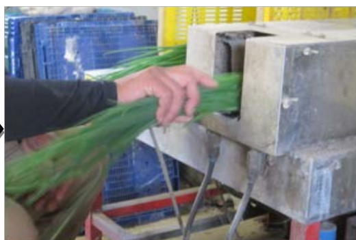
根元部分を皮むき機に入れ、水圧で余分な皮や汚れを飛ばします。
