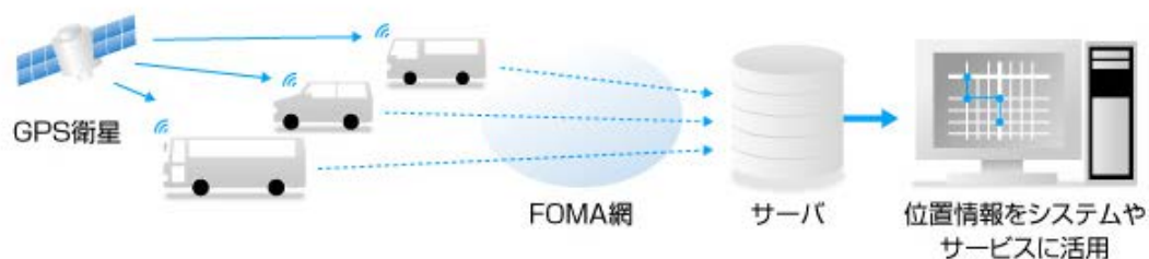
図1 GPS 位置情報専用車載端末 BCL-100 の閲覧システム (VISH 株式会社のホームページから引用)
