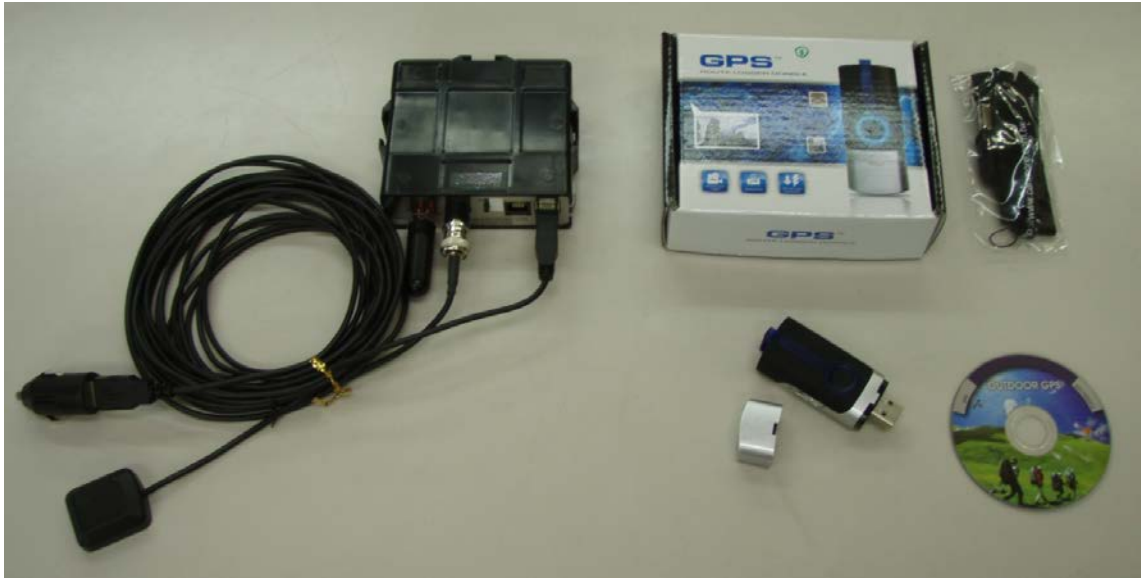
写真 1 GPS 位置情報専用車載端末 BCL-100(左)と USB 接続 GPS データロガーGT-730FL-S(右)
