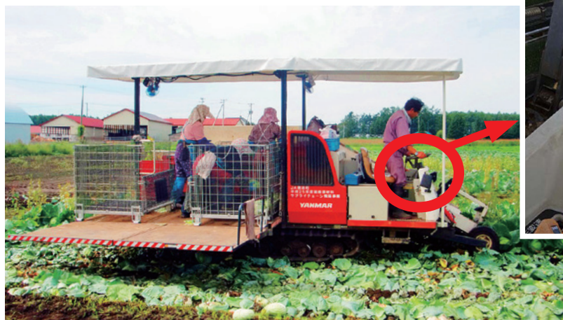
写真3 バックモニターやセンサー類により、経験の浅いオペレータでもキャベツのCutting精度を大幅に向上 (写真提供：農研機構北海道農業研究センター)
