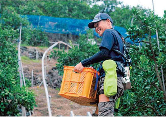
写真2 荷物の持ち上げ・運搬、中腰姿勢、傾斜地歩行をアシストするパワーアシストスーツ（写真提供：和歌山大学）
