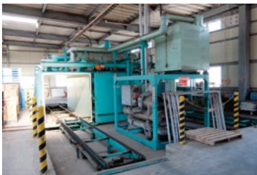
野菜の鮮度を長持ちさせるため短時間で急速冷却ができる真空冷却器
