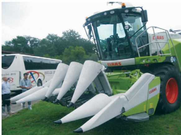
写真3 イアコーン収穫用自走式ハーベスタ（左）と普通コンバイン（右）いずれも雌穂収穫専用アタッチメントを装着している
