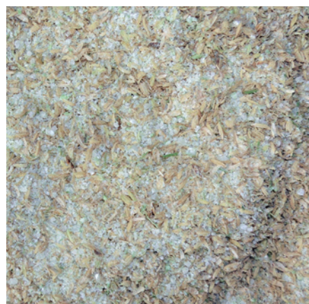
写真3 ハンマーミル式破碎装置で破碎した粃米
