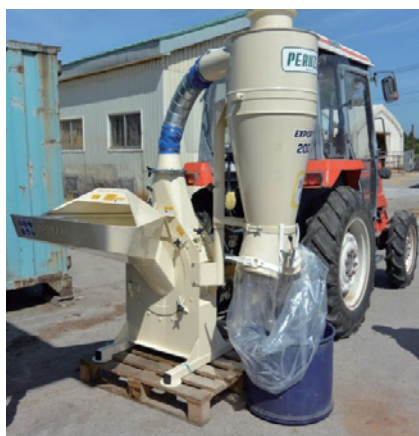
写真2 ハンマーミル式破碎装置
