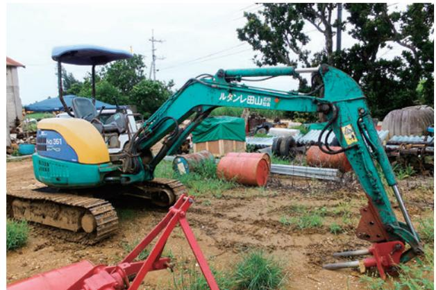
写真6 硬い土壌に補植用の穴を開けるバックホウ
