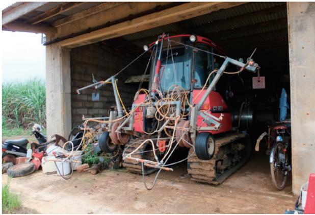
写真4 一度に4畦に農薬散布できるように改良した機械
