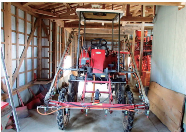
写真8 自走式除草剤散布機 (ブームスプレーヤ)
