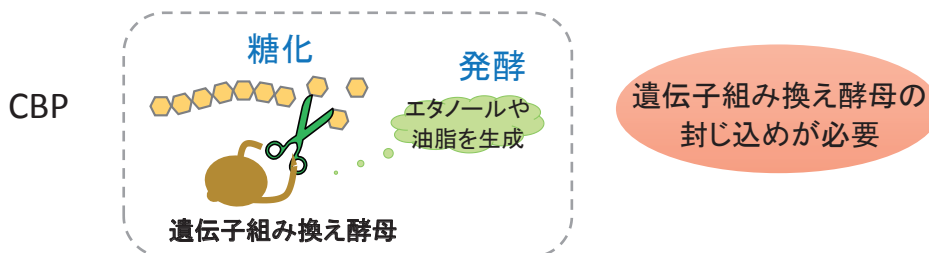
図5 酵母を用いたバイオ燃料の製造方法 (遺伝子組み換え酵母)
