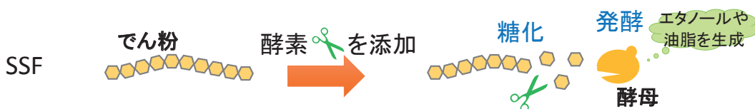
図3 酵母を用いたバイオ燃料の製造方法 (SSF)
