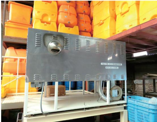
写真3 オリーブ搾油粕の乾燥施設
