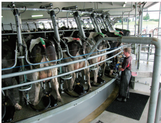
写真3 ワイカト地方中部の酪農家の搾乳施設。150ヘクタールの放牧地で約450頭の乳牛を飼養（同地方の平均を少し上回る経営規模）。常勤従業員は写真中央右のアイランド人1名のみで、50頭同時に搾乳できるロータリーパーラーで朝5時半と午後1時半、計2回の搾乳を行っている。
