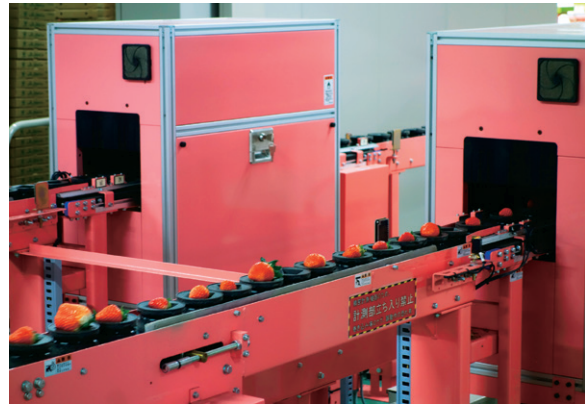
写真2 パンに乗ったいちごの内部品質を計測するいちごセンサー
