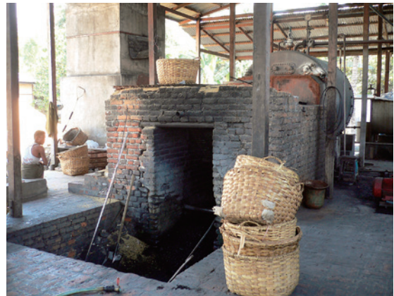
写真11 生乳処理場の加糖れん乳製造機 （熱源に粃殻を使用しコストを抑制）
