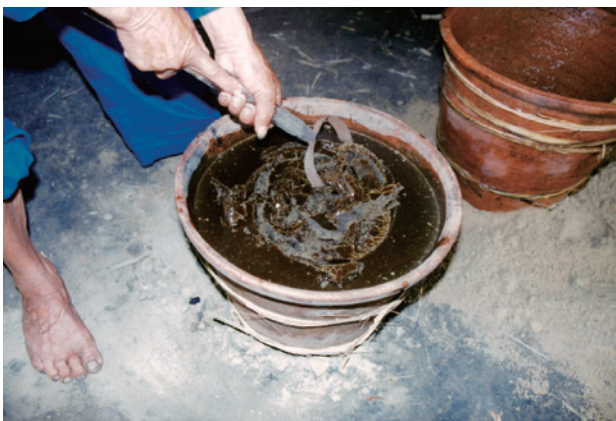
写真13 固化した砂糖の表面を削る様子
