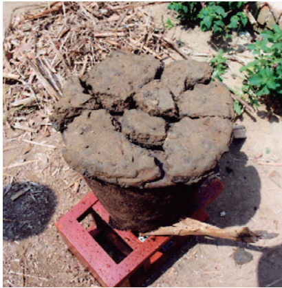
写真8 土の表面に毛管現象によるとみられる黒い色素の移行が見られる
