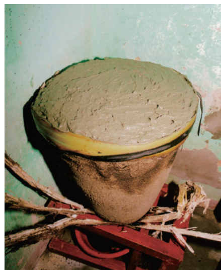
写真7 砂糖の上面を土で塗りふさいだ様子
