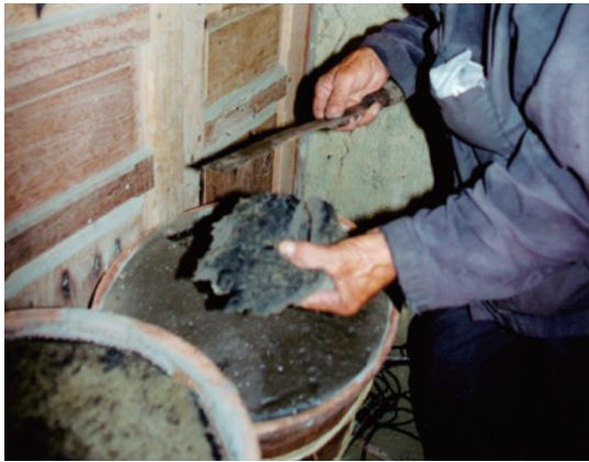
写真16 取り除いた土の砂糖との接触面が黒くなっていることが分かる
