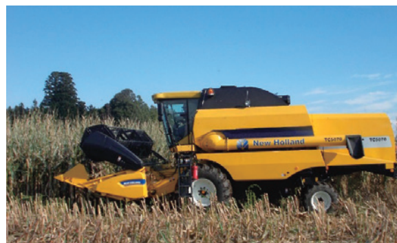
写真2 普通コンバインによるトウモロコシ子実の収穫
