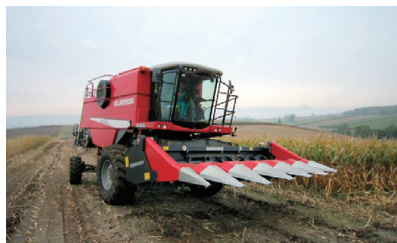
写真1 スナッパヘッドを装着した普通コンバイン （農研機構畜産研究部門 野中氏撮影）
