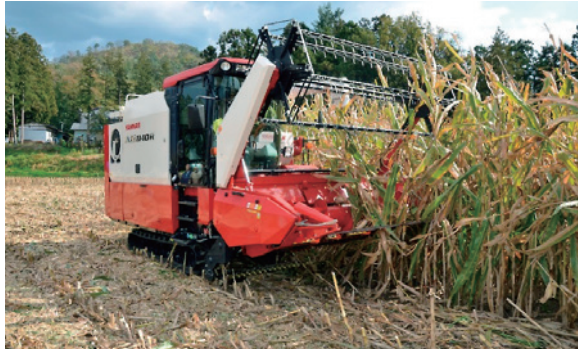
写真3 国産汎用コンバインによるトウモロコシ子実の収穫（農研機構畜産研究部門 森田氏撮影）
