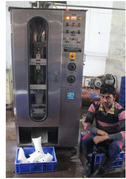
牛乳をパウチに詰める機械 （160頭飼養する酪農経営）
