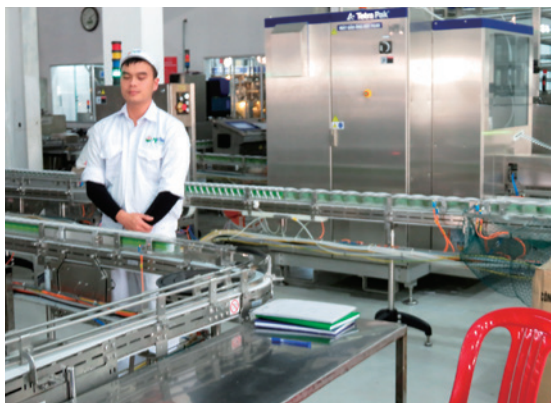
写真13 テトラパック社製のUHT牛乳などの製造ライン
