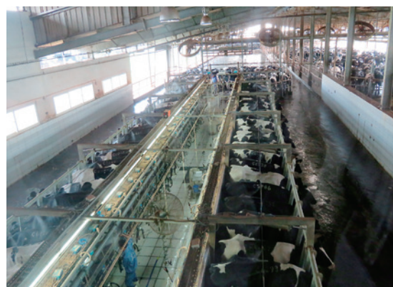
写真12 1回に60頭が搾乳できる並列対尻式パーラー
