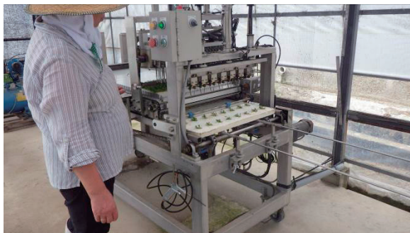
写真2 苗定植機（スポンジで育苗した苗をパネルに定植する）
