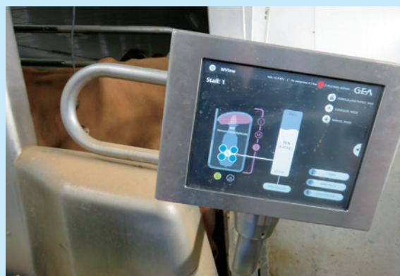
コラム写真2 搾乳ロボット付属の液晶画面 個体識別情報や搾乳の進捗 しんちよく を確認可能
