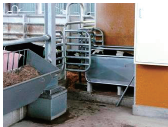
写真3 哺乳ロボット 1頭ごとの管理が可能となっている
