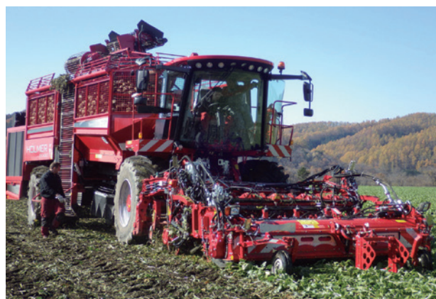
写真2 てん菜多畝(6条)収穫機(ドイツホルマー社製)
