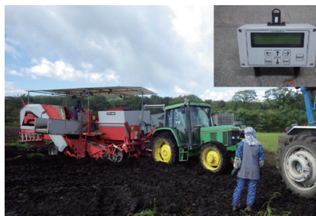
写真1 収量センサーを取り付けた国産ばれいしょ収穫機 (写真右上は収量モニター)
