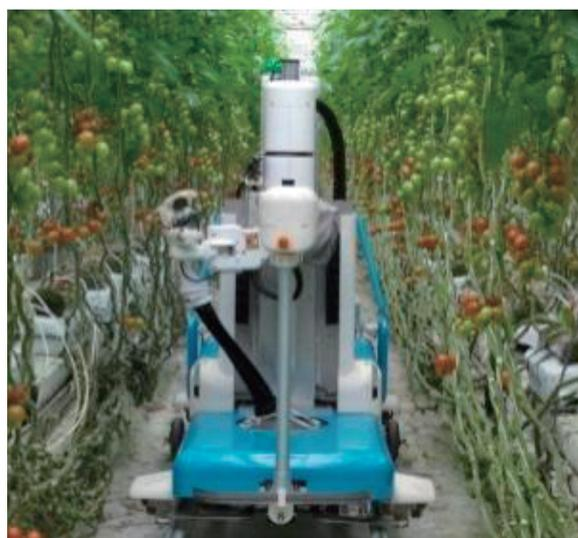
写真1 企業が開発を進めているトマト収穫ロボット
