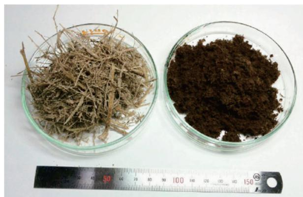
写真2 水熱処理前後のバガス
