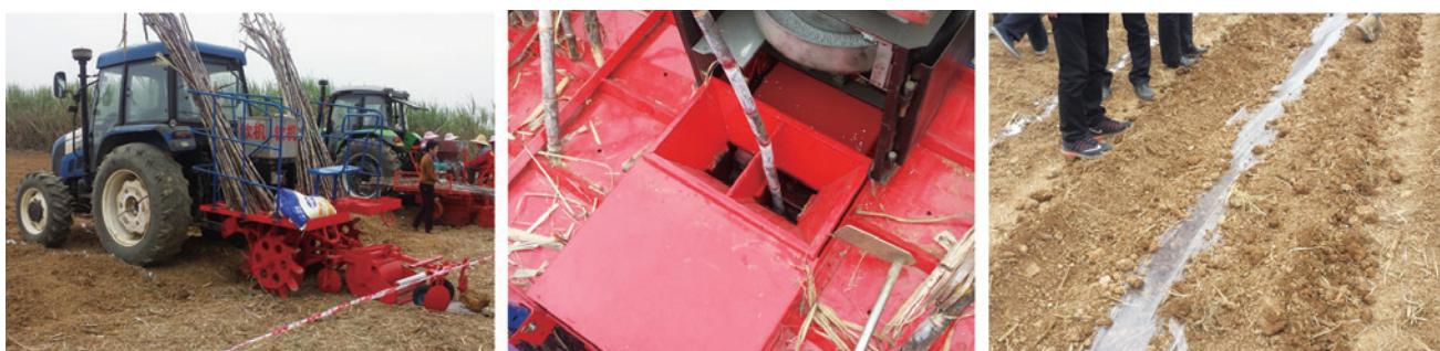
図3 植え付け・ビニールマルチングを同時に行う2条植えプランタ
