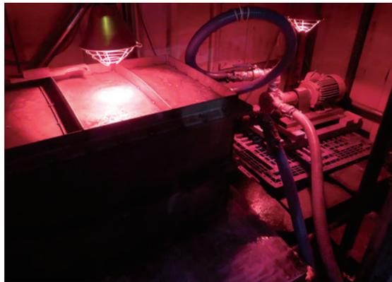
写真8 かき混ぜたリキッドを加熱して発酵しやすくするための機械
