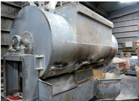
写真7 原料を細かく粉状にし、液体に溶けやすくする機械
